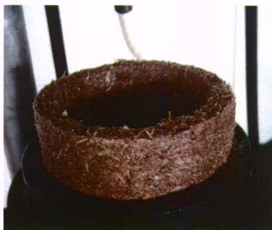
รูปที่ 3.4 ลักษณะของกระถางต้นไม้ที่ขึ้นออกมาจากแม่พิมพ์
