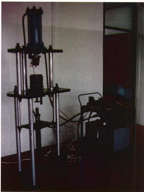
รูปที่ 3.2 เครื่องอัดกระถางต้นไม้ระบบไฮดรอลิก
