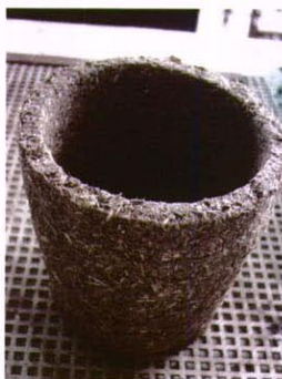
รูปที่ 3.5 ลักษณะของกระถางต้นไม้ที่ขึ้นรูปและนำออกจากแม่พิมพ์
