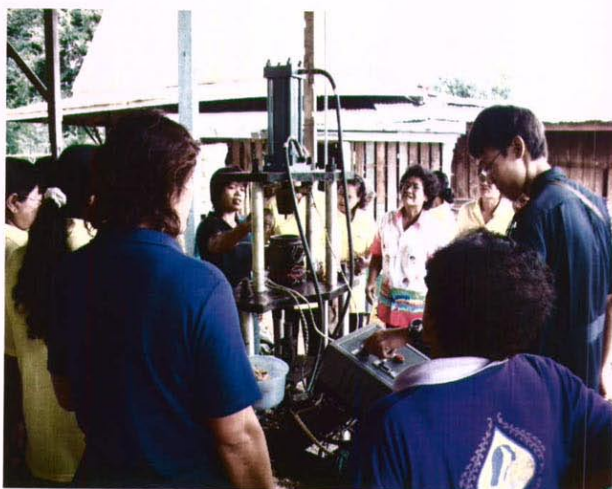
รูปที่ 4.12 ผู้เข้าอบรมขึ้นรูปกระถางต้นไม้จากวัสดุเหลือใช้ทางเกษตรด้วยเครื่องอัดระบบไฮดรอลิก
