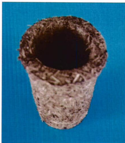
รูปที่ 4.8 ลักษณะของกระถางต้นไม้ออกจากแม่พิมพ์ทรงกรวยขนาดเล็ก
