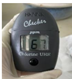
นำ reagent A และ reagent B ใส่ในคิวเวท แล้วนำไปใส่เครื่องวัดคลอรีน และอ่านค่าปริมาณคลอรีน
