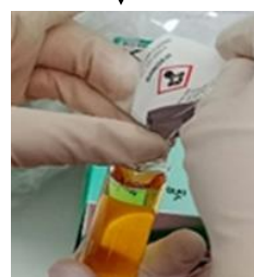
นำ reagent A และ reagent B ใส่ในคิวเวท แล้วนำไปใส่เครื่องวัดคลอรีน และอ่านค่าปริมาณคลอรีน
