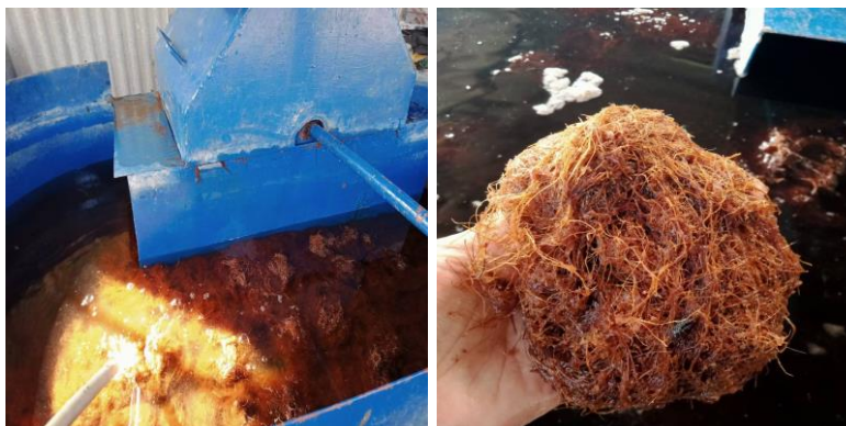
รูปที่ 4.12 การปั่นตีเยื่อและลักษณะเยื่อที่ได้
