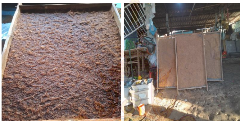
รูปที่ 4.13 การขึ้นแผ่นกระดาศมะพร้าวของกลุ่มวิสาหกิจชุมชน
