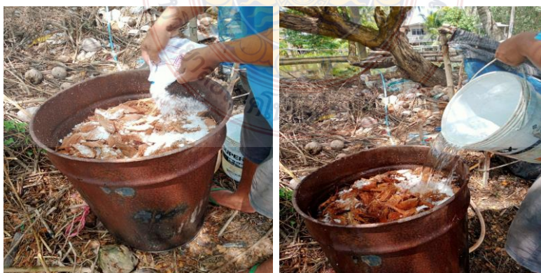
รูปที่ 4.11 การเตรียมกระดาดมะพร้าวเพื่อพอกเยื่อในแกลลอน
