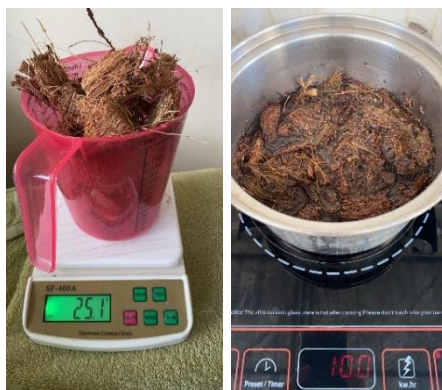
รูปที่ 4.14 การต้มฟอกเยื่อที่ชุ่มซนดำเนินการ
