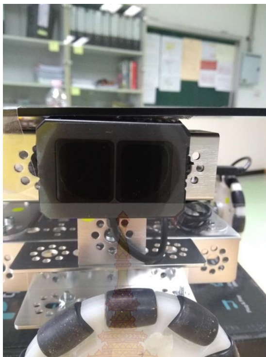
ภาพที่ 3.12 การติดตั้งไล้ด้า
