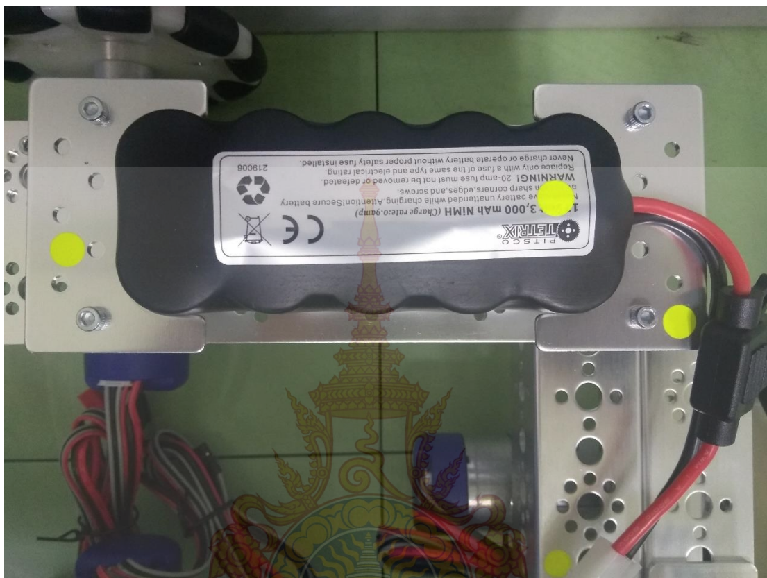
ภาพที่ 3.11 การติดตั้งแบตเตอรี่
