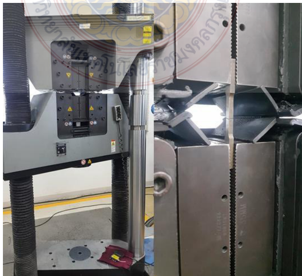
รูปที่ 3.13 การจับยึดชิ้นงานเข้ากับเครื่องด้วยปากกาจับยึดของเครื่องทดสอบแรงดึง
