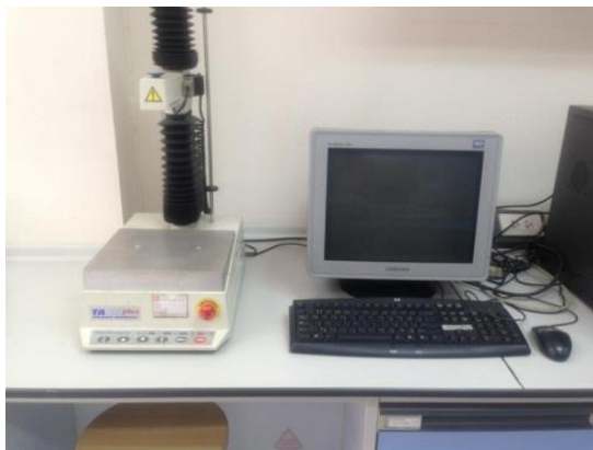
ภาพที่ ก 1.2 เครื่องวัดลักษณะเนื้อสัมผัส (Texture Analyzer)
