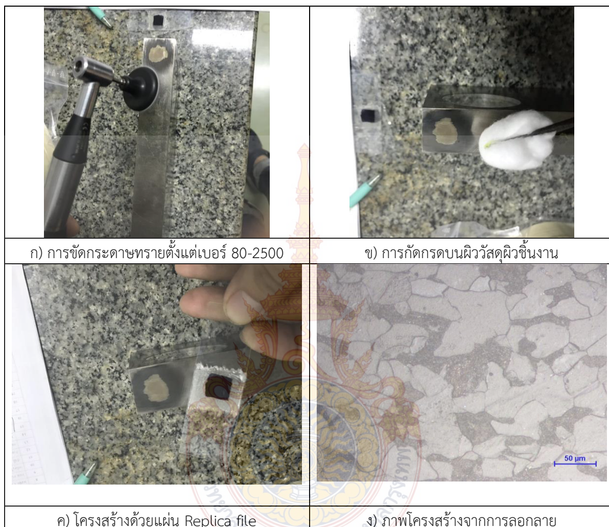
รูปที่ 3.2 ขั้นตอนการทดสอบด้วยเทคนิค Replication
