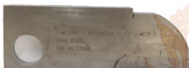
รูปที่ 2 แท่งสอบเทียบมาตรฐานคลื่นเสียง IIV TYPE V1 ตามมาตรฐาน ASTM E164 จากต่างประเทศ
