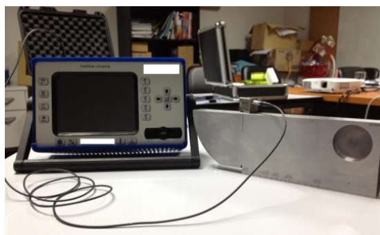
รูปที่ 2.14 เครื่องมือทดสอบคลื่นเสียงความถี่สูงและชิ้นงานสอบเทียบมาตรฐาน IIW Block
