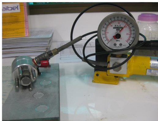
รูปที่ 2.15 ทดสอบการยึดเกาะผิวอลูมิเนียม วิธี Pull off Test
