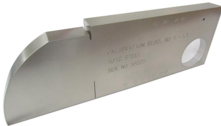
รูปที่ 2.4 แท่งสอบเทียบมาตรฐาน V1
