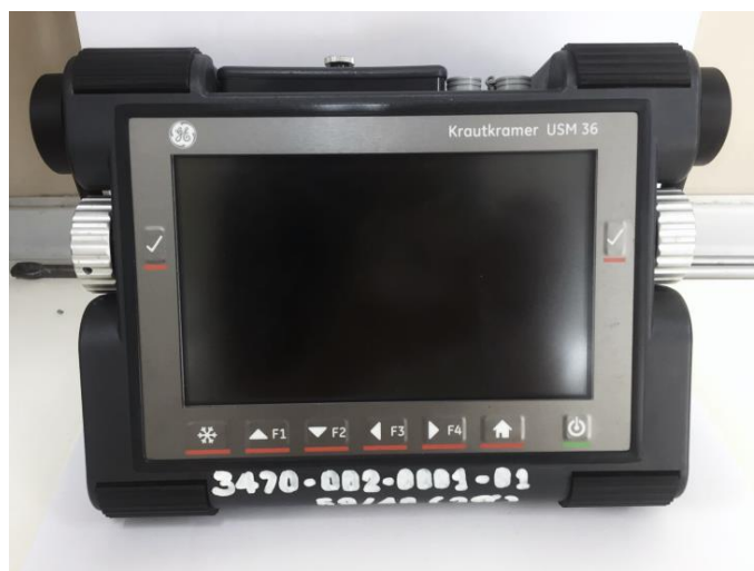
ก) เครื่องตรวจสอบด้วยคลื่นเสียงความถี่สูง (Ultrasonic testing) รุ่น Krautkramer USM 36
