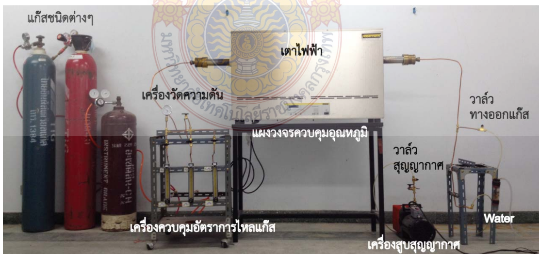
ภาพที่ 8 ภาพถ่ายระบบการตกสะเก็ดไอเชิงเคมีด้วยความร้อน
