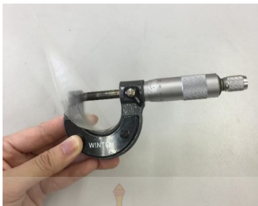
รูปภาพผนวก ก1 การสุ่มวัดความหนาของฟิล์มด้วยไมโครมิเตอร์
