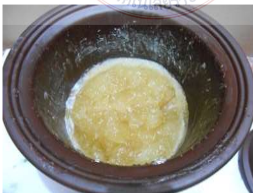
เก็บตัวอย่าง มาละลายในน้ำร้อน ทุกๆ 30 นาที จนกว่าตัวอย่างที่นำมาละลายในน้ำร้อนจะมีลักษณะใส ไม่ขุ่น ซึ่งสิ่งที่ได้ คือ หัวสบู่
