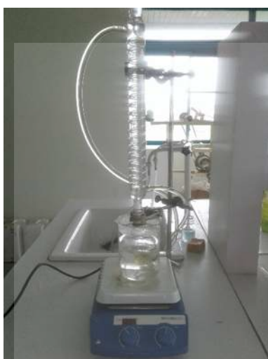
รีฟลักซ์น้ำมันมะพร้าวด้วย KOH
