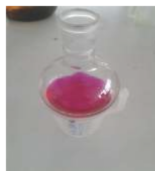
ไทเทรตด้วย HCl 0.5 M ใช้ฟีนอล์ฟทาลีนเป็นอินดิเคเตอร์
