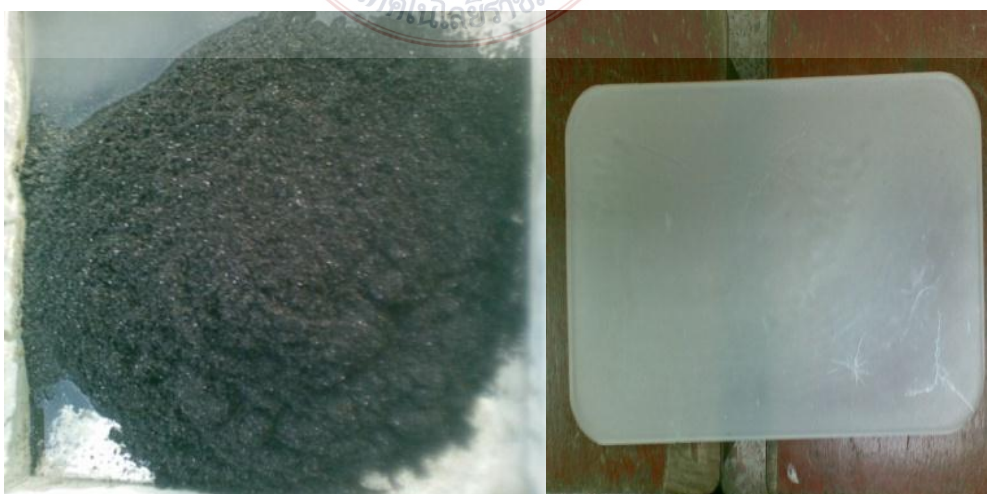
ภาพที่ 3.3 เตรียมหินแกรนิตบดและการเตรียมแผ่นพาราฟิน
