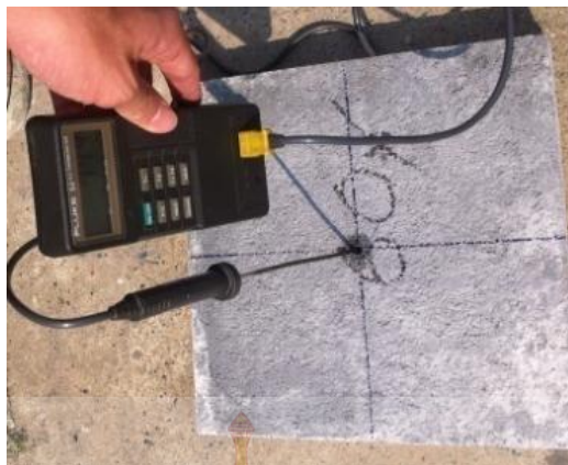
ภาพที่ 3.9 แสดงการทดสอบวัดค่าความร้อนจากแผ่นตัวอย่าง
