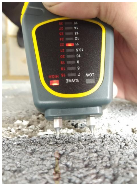
ภาพที่ 4.11 การวัดค่าความชื้นตามจุดทดสอบต่าง ๆ ของคอนกรีตบล็อกในโรงอบจำลอง
