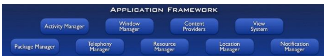
ภาพที่ 2.28 โครงสร้างชั้นแอปพลิเคชันเฟรมเวิร์ค (Application Framework)
