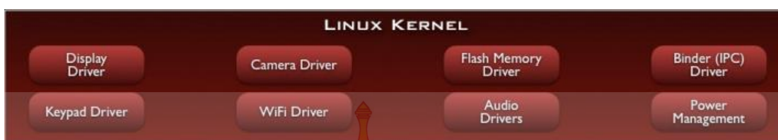
ภาพที่ 2.30 โครงสร้างชั้นเคอร์เนลของลินุกซ์
