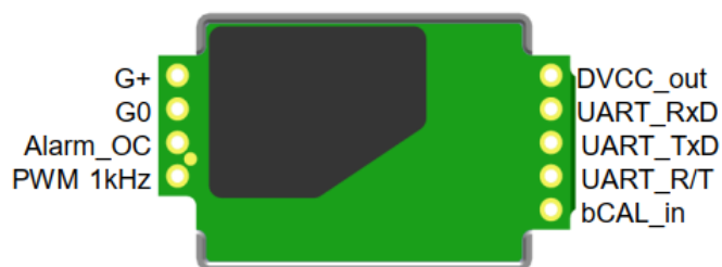
ภาพที่ 2.22 ตำแหน่งขาของโมดูลเซ็นเซอร์ก๊าซคาร์บอนไดออกไซด์ [8]
