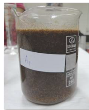
สกัดด้วยสารละลาย โซเดียมไฮดรอกไซด์เข้มข้นร้อยละ 20 นาน 24 ชั่วโมง
