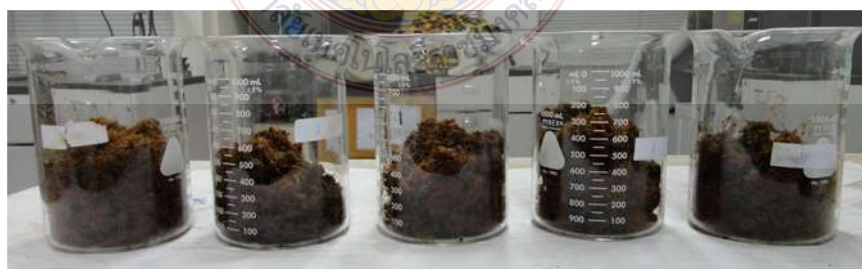
รูปที่ 4.1.2 เส้นใยเซลลูโลสจากไยมะพร้าวด้วยโซเดียมไฮดรอกไซด์
