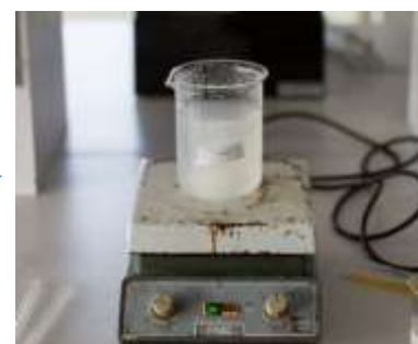
ละลายด้วยน้ำร้อน และกวนด้วยเครื่องกวนแม่เหล็ก
