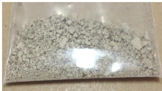
รูปที่ 1.1 สารสกัดโบรมีเลนจากน้ำคั้นเหง้าสัปะรดที่ทำให้แห้งด้วยวิธีอบแห้งแบบแช่แข็ง
