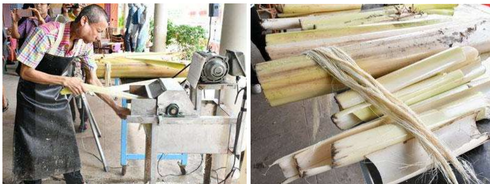
รูปที่ 2.11 การแยกเส้นใยด้วยเครื่องขูดหรือเครื่องรีด
