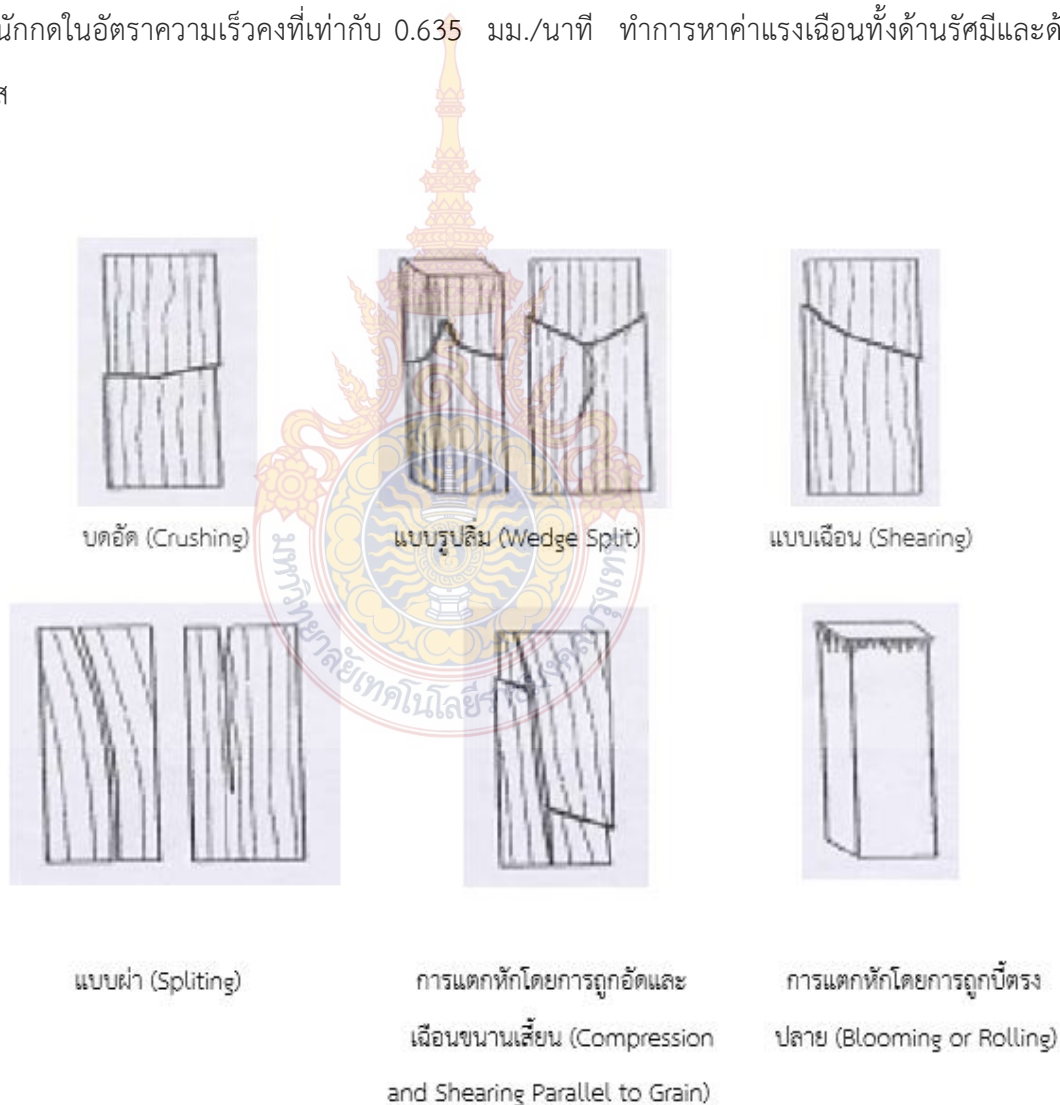
ภาพประกอบที่ 2.6 แสดงรูปแบบการวิบัติของไม้
