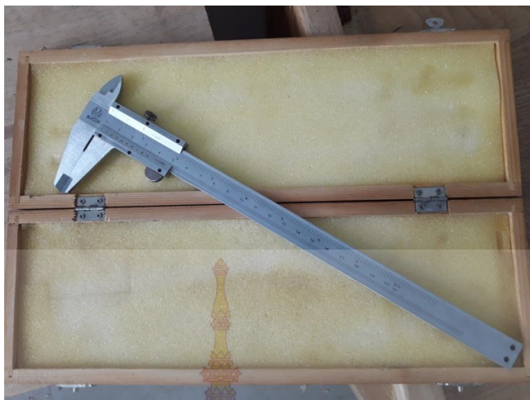
ภาพประกอบที่ 3.3 เวอร์เนียของสาขาวิชาเทคโนโลยีเครื่องเรือนและการออกแบบ
