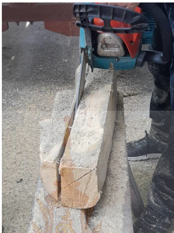
ภาพประกอบที่ 3.7 ท่อนไม้สารจากสวนป่าในจังหวัดนครราชสีมานำมาเลื่อยเปิดปีกไม้
