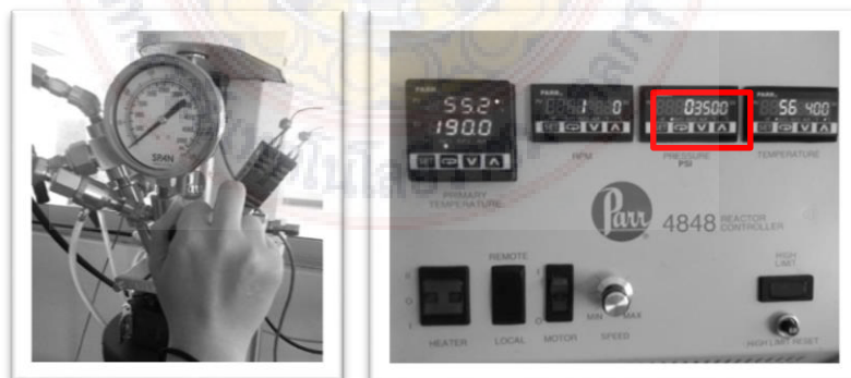
รูปที่ ณ.2 (a) วิธีการปล่อยความดันออก (b) หน้าจอแสดงผลเมื่อปล่อยความดันออกหมด
