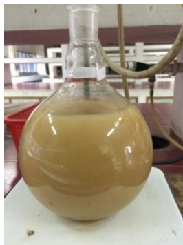
ภาพที่ 4.12 การทำปฏิกิริยาด้วยกรดซัลฟูริก แร่เคโอลิไนต์จากแหล่งระนอง
