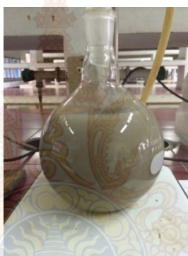
ภาพที่ 4.13 การทำปฏิกิริยาด้วยกรดซัลฟูริก แร่เคโอลิไนต์จากแหล่งลำปาง
