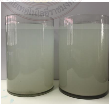
ภาพที่ 4.11 การทำปฏิกิริยาเคมีแร่เคโอลินได้จากแหล่งระนอง(ซ้าย) และแหล่งลำปาง(ขวา) หลังการทำปฏิกิริยาด้วยออกซาลิก
