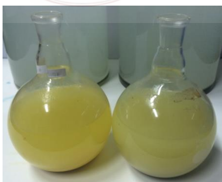
ภาพที่ 4.14 แร่เคโอลิไนต์ลำปาง หลังการทำปฏิกิริยาด้วยซัลฟูริก
