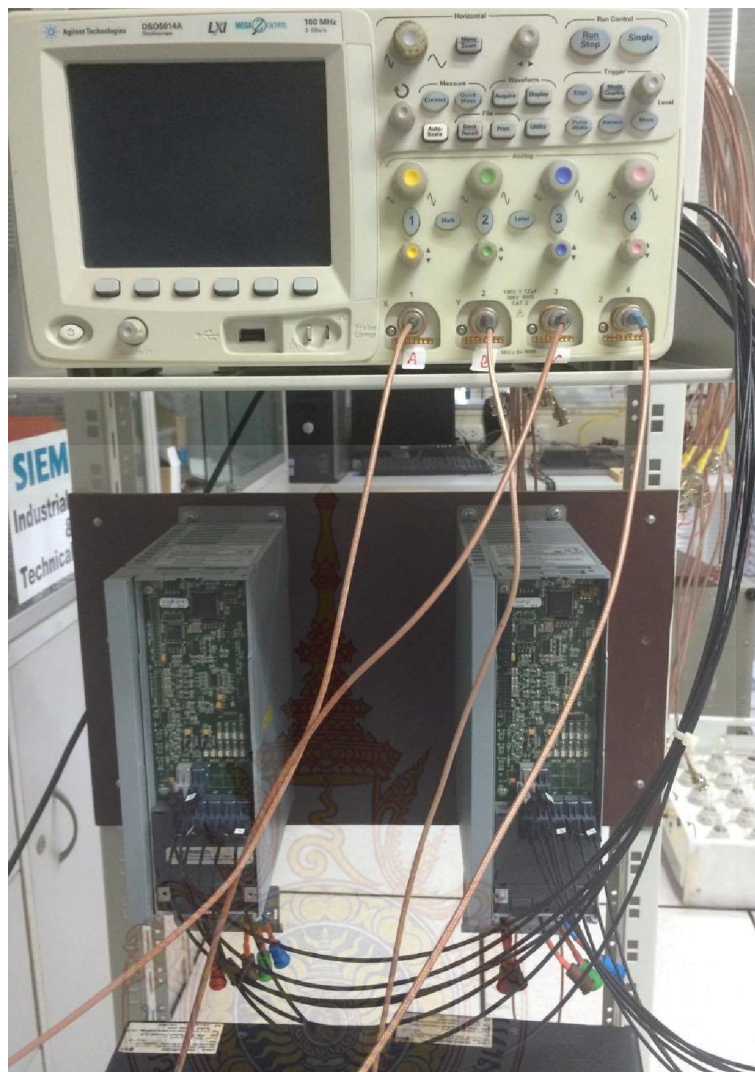
ภาพที่ 4.10 ภาพวงจรคอนเวอร์เตอร์ 2 โมดูลที่ใช้ในการทดลองงานวิจัย
