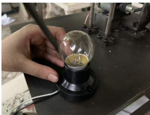
ภาพที่ 3.9 แสดงการติดตั้งหลอดไฟ
