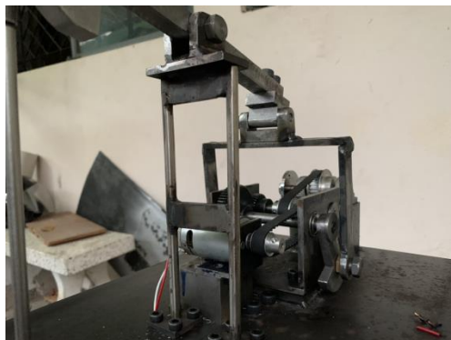
ภาพที่ 3.7 ติดตั้งยึดส่วนประกอบชุดปั๊มหัวม้า
