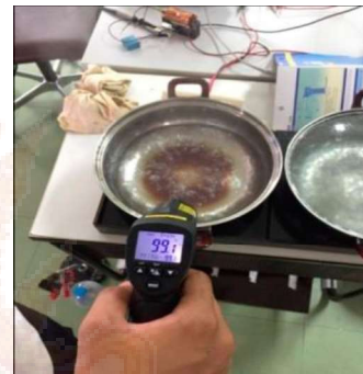
ภาพที่ 19 วัดอุณหภูมิเอาต์พุต 1 ได้ประมาณ 99 องศาเซลเซียส ภายใน 3 นาที
