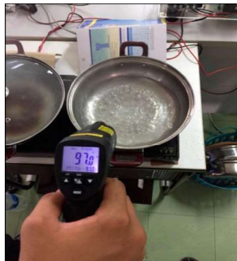
ภาพที่ 21 วัดอุณหภูมิเอาต์พุต 2 ได้ 97 องศาเซลเซียส ภายใน 3 นาที
