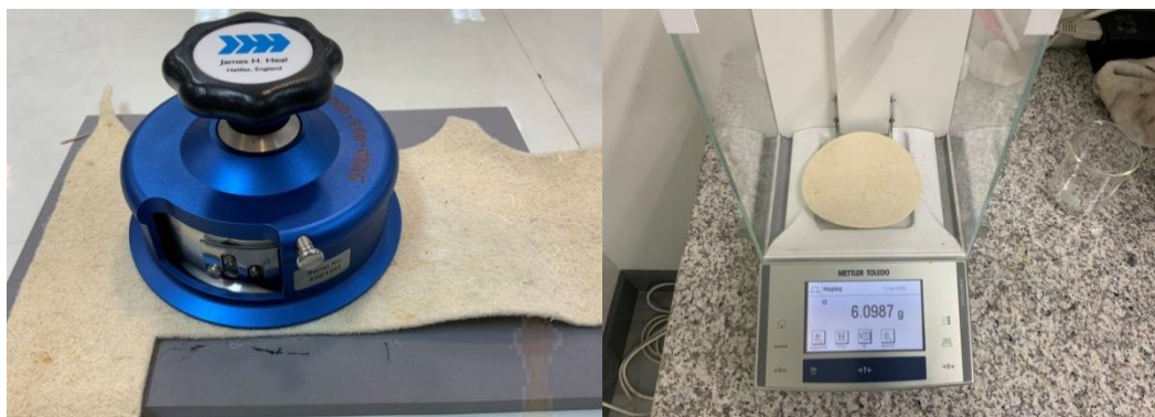
ภาพที่ 3.9 อุปกรณ์การทดสอบหาน้ำหนักของแผ่นผ้าไม่ทอ
