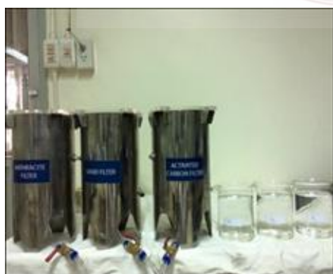
ถ่านแอนทราไซต์ ทรายและถ่านกัมมันต์
