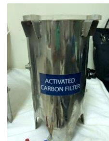
ถังกรองถ่านกัมมันต์
