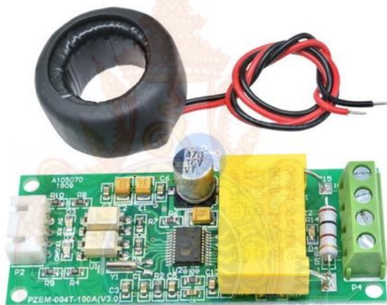
ภาพที่ 2.2 เซนเซอร์-วัดพลังงานไฟฟ้า PZEM004T
