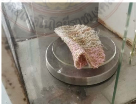
ภาพที่ 3.17 การทดสอบหาน้ำหนักผ้า
