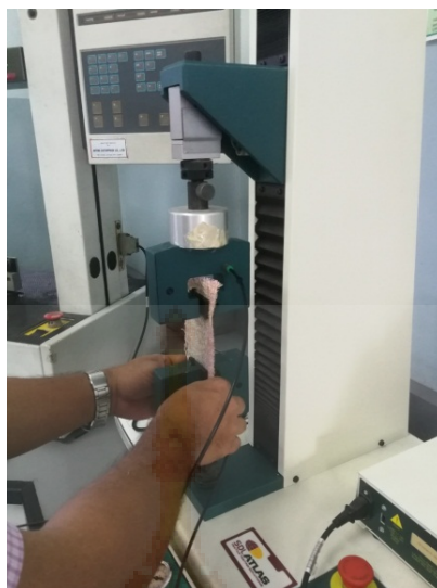
ภาพที่ 3.16 การทดสอบความแข็งแรงของผ้าทอ
