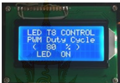
รูปที่ 4.31 ทดสอบโดยการเปิดใช้งานของชุดปรับความสว่างค่าวัฏจักรอยู่ที่ 80% แรงดันเอาต์พุต 10.73 โวลต์ กระแสเอาต์พุต 1.23 แอมป์
