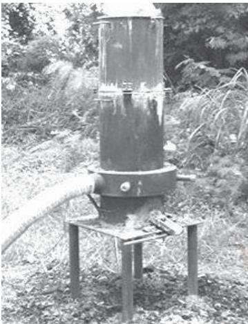
ภาพที่ 5 เตาถลุงสินแร่เหล็กน้ำพี้แบบคิวโปลา
