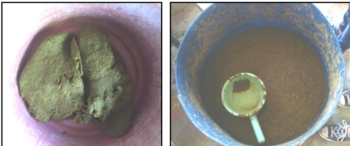
ภาพที่ 7 ทำการเทเส้นใยสับปะรดที่ผ่านการล้างลงในกะละมัง เส้นใยจะมีสีคล้ำมาก จากนั้นทำการฟอกสีด้วยคลอรีน อัตราส่วนที่ใช้ คือ ใช้คลอรีน 1 กิโลกรัมผสมกับน้ำจำนวน 30 ลิตร แช่ทิ้งเพื่อฟอกสีประมาณ 2-3 ชั่วโมง
