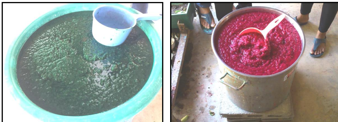
ภาพที่ 9 การย้อมสีจะเริ่มด้วยการนำเยื่อสับปรดมาใส่ในภาชนะที่มีน้ำสะอาด ทำการละลายสีย้อมในอัตราส่วนน้ำ 2 ลิตร เกลือป่นครึ่งถุงเล็ก และสีย้อมผ้าประมาณ 5 ชอง ใส่สีลงในเยื่อสับปรด คนสีให้เข้ากันทั่วกับเยื่อสับปรด หลังจากนั้นทำการแช่สีไว้ข้ามคืน
