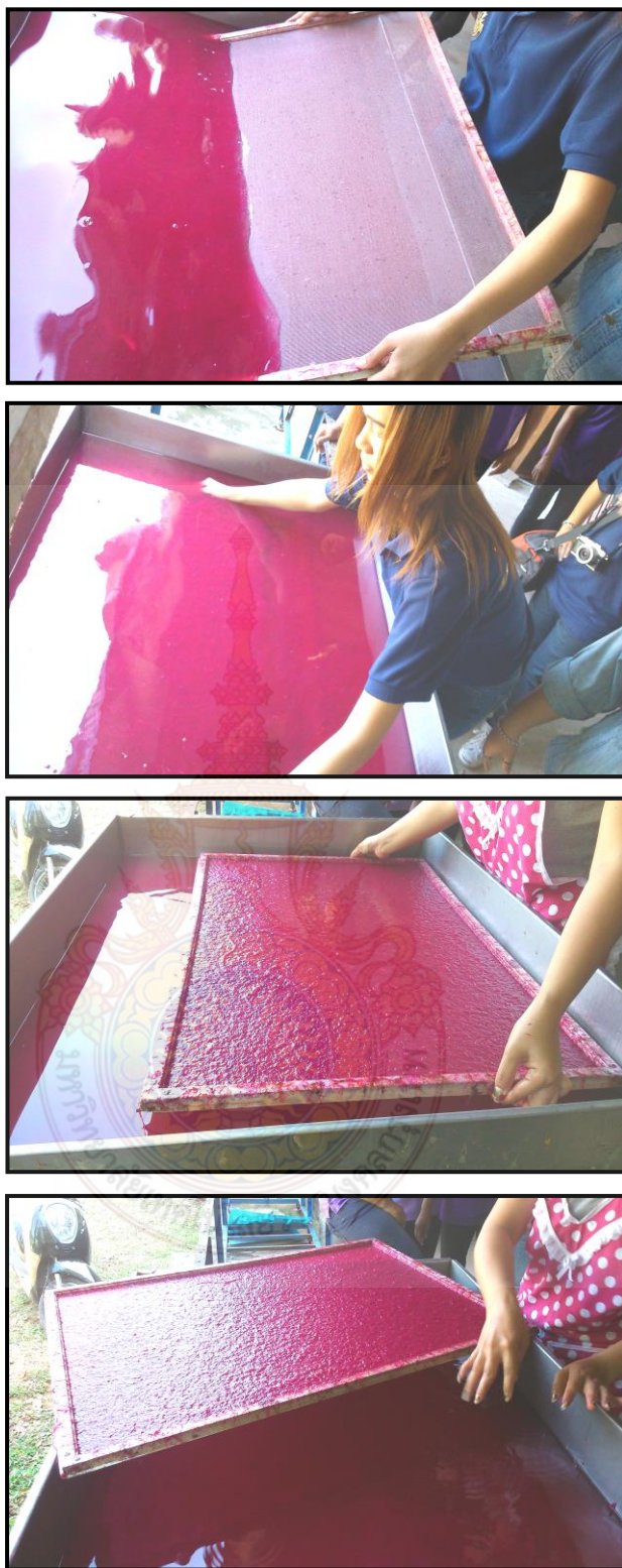
ภาพที่ 11 นำตะแกรง(เฟรม) มุ่งลวดจุ่มลงในกระบะเพื่อทำการช้อนเอาเยื่อใบสับปะรดให้ติดตะแกรง ต้องให้เยื่อกระจายอยู่บนตะแกรงให้สม่ำเสมอและราบเรียบเป็นแผ่นเดียวกันในขณะที่ทำ การยกขึ้นพ่นน้ำ ความหนาหรือบางของกระดาษจะขึ้นอยู่กับเยื่อใบสับปะรดที่ติดขึ้นมา
