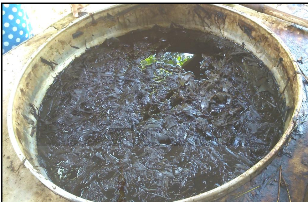
ภาพที่ 5 เมื่อต้มใบสับปะรดประมาณ 4-5 ชั่วโมง ใบสับปะรดจะเปื่อย และมีสีคล้ำมากขึ้น
