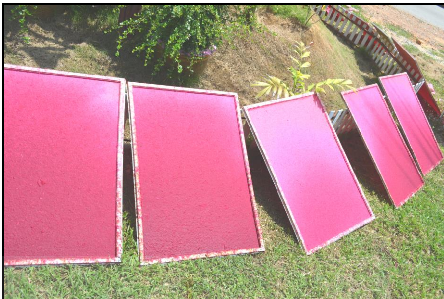
ภาพที่ 12 นำตะแกรงที่มีเยื่อใบสับปรดมาพักให้แห้งพอมดๆ จากนั้นนำไปผึ่งแดดประมาณหนึ่งวัน เมื่อกระดาษแห้งจึงทำการค่อยๆ แกะกระดาษใบสับปรดออกจากตะแกรง
