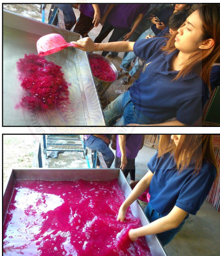
ภาพที่ 10 ถ่ายเยื่อกระดาษลงในกระบะที่มีน้ำสะอาดไว้ ใ้มีมือคนให้เยื่อใบสับปรดกระจายออกสม่ำเสมอทั่วทั้งกระบะ
