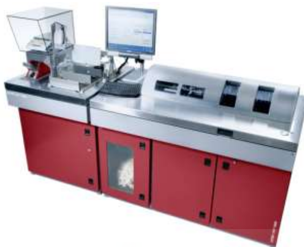
รูปที่ 3.2 เครื่อง USTER® HVI 1000
