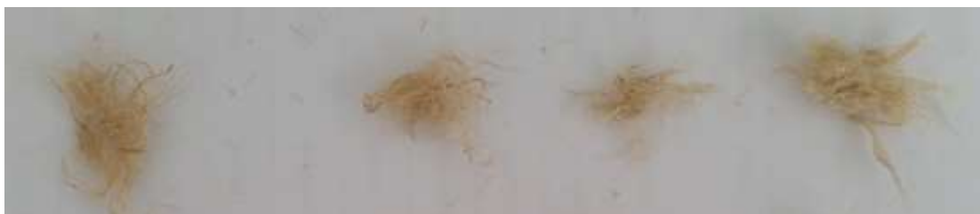
รูปที่ 4.7 ลักษณะของเส้นใยกล้วยหลังการกำจัดสิ่งสกปรกด้วยสารละลายโซเดียมไฮดรอกไซด์ ความเข้มข้นร้อยละ 10 โดยน้ำหนักต่อปริมาตรที่เวลาต่างกัน (ก) 1 ชั่วโมง (ข) 2.5 ชั่วโมง (ค) 4 ชั่วโมง (ง) 5.5 ชั่วโมง
