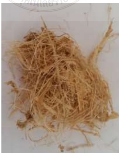
รูปที่ 4.6 ลักษณะของเส้นใยกล้วยก่อนการกำจัดสิ่งสกปรก
