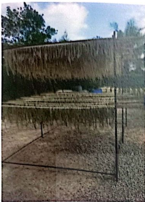
รูปที่ 4.4 เส้นใยสับปะรดที่แยกด้วยกระบวนการเชิงกล และตากแห้ง
