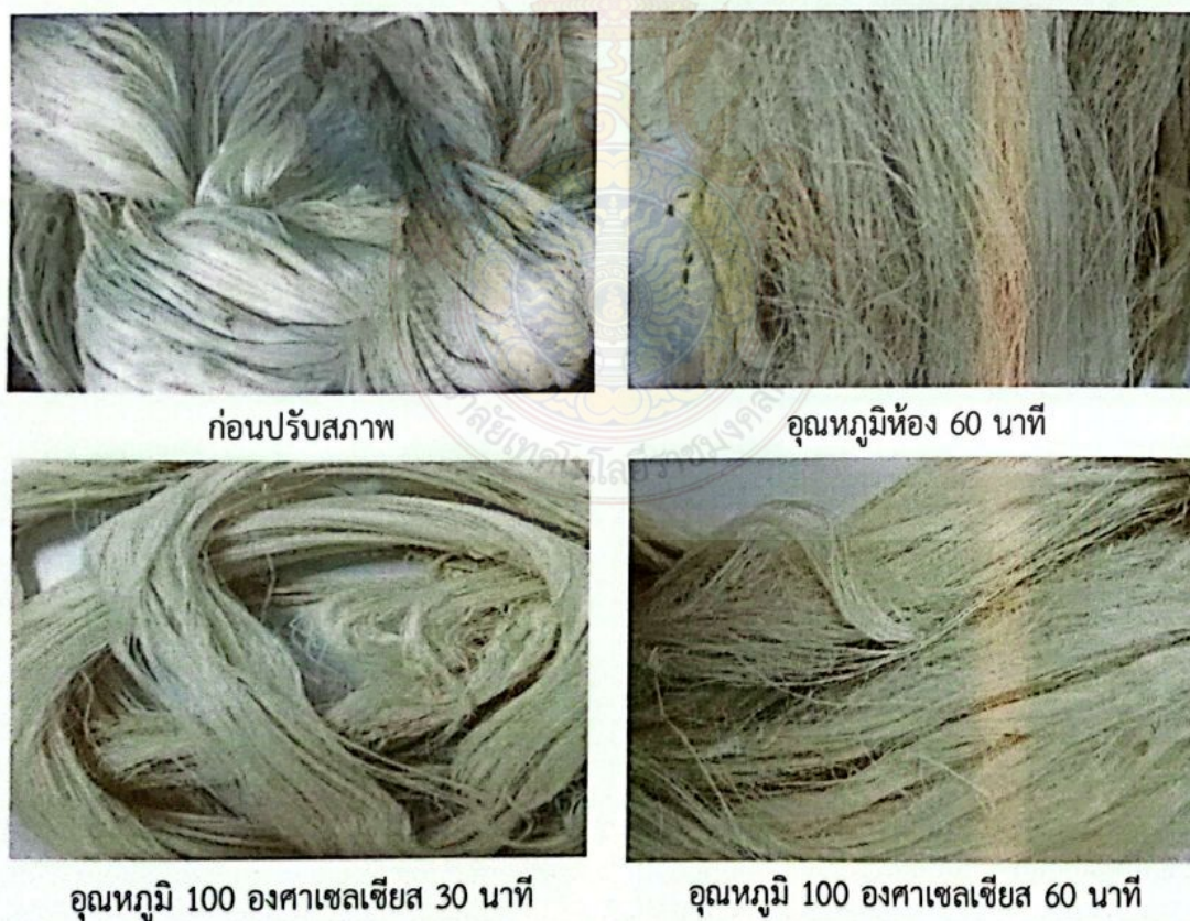
รูปที่ 4.6 ลักษณะของเส้นใยหลังทำความสะอาดด้วยน้ำประปาที่เวลาแช่น้ำและอุณหภูมิต่างกัน
