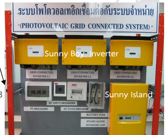
รูปที่ 10 อินเวอร์เตอร์แบบต่อเข้าระบบจำหน่ายที่ติดตั้ง ณ ห้อง 503 สาขาวิชาวิศวกรรมไฟฟ้า อาคาร 48 คณะวิศวกรรมศาสตร์
