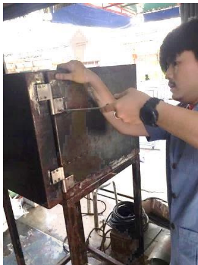
ภาพที่ 3.7 ติดตั้งบานพับและมือจับล็อกฝาตู้อบ
