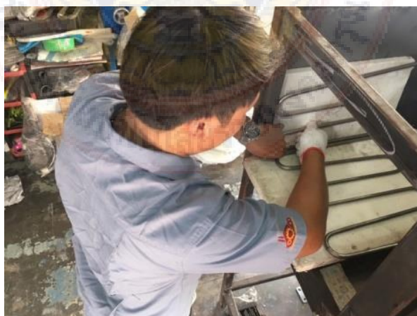
ภาพที่ 3.10 ติดตั้งฮีเตอร์ฮอตทรานเนอร์และชุดควบคุมอุณหภูมิ
