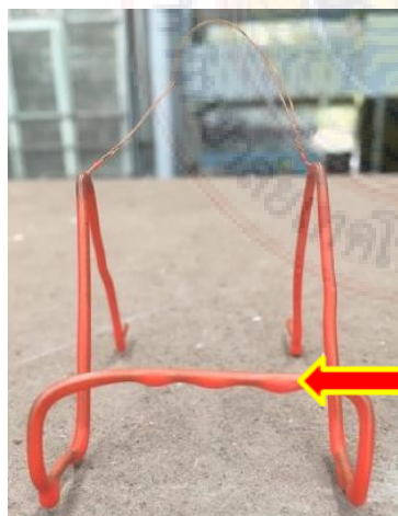
ดังภาพที่ 3.24 อบเคลือบชิ้นงานด้วยอุณหภูมิ 240 องศาเซลเซียส เป็นเวลา 16 วินาที
