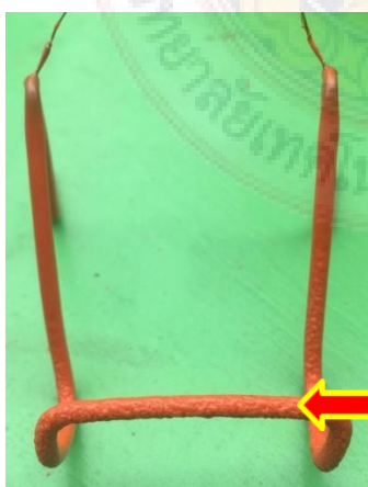
ภาพที่ 3.22 อบเคลือบชิ้นงานด้วยอุณหภูมิ 240 องศาเซลเซียส เป็นเวลา 14 วินาที
