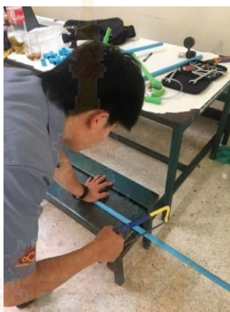
ภาพที่ 3.13 ตัดท่อพีวีซี เพื่อนำมาประกอบเป็นท่อทางเดินลมเป่าผงพลาสติก
