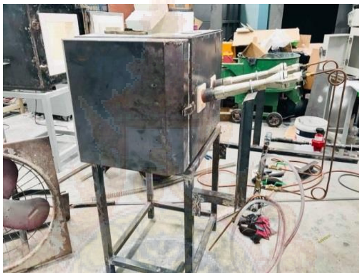
ภาพที่ 3.9 ภาพการติดตั้งชุดให้ความร้อน
