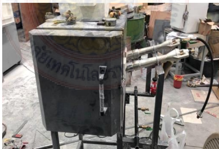
ภาพที่ 3.8 ภาพการติดตั้งที่ยึดหัวเผาและท่อแก๊ส
