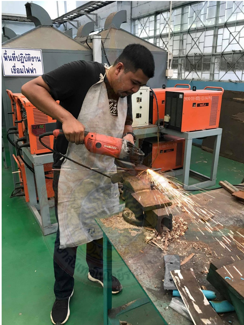
ภาพที่ ค 6 ภาพการเจียรระไนรูปทรงและลับคม
