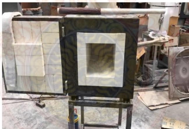
ภาพที่ 3.6 ภาพการติดตั้งเตาและฐานเตา
