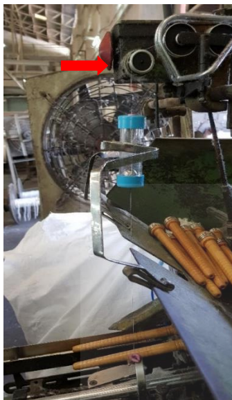
ภาพที่ 3.7 ชุดอุปกรณ์ควบคุมความตึงลูกเหล็กผ่านหัวหมุนหน้า
