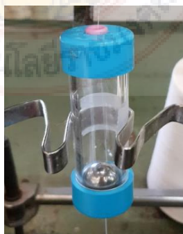
ภาพที่ 3.2 อุปกรณ์ควบคุมความตึงเส้นด้ายด้วยลูกเหล็ก
