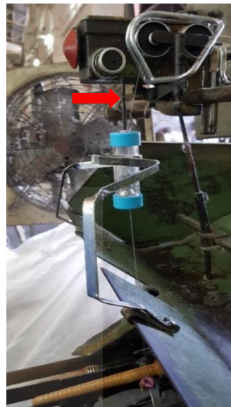
ภาพที่ 3.8 ชุดอุปกรณ์ควบคุมความตึงลูกเหล็กไม่ผ่านหัวหมุนหน้า
