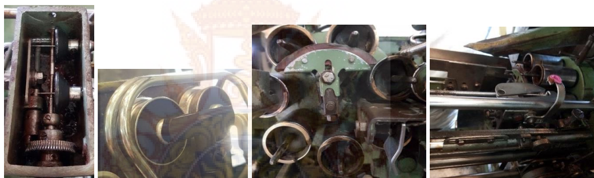
ภาพที่ 3.6 ชุดอุปกรณ์กรอตัด้ายปกติหลังปรับปรุง
