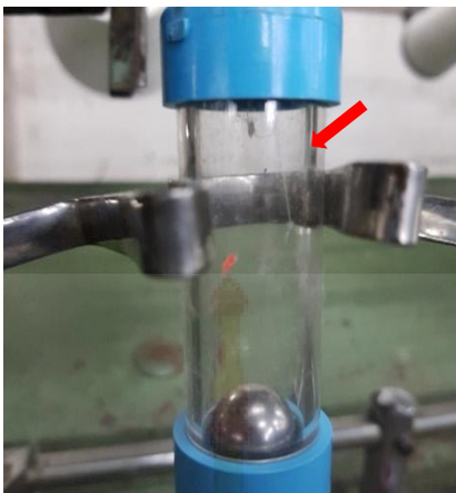
ภาพที่ 5.1 ตัวอย่างการขาดของเส้นด้ายในหลอดอุปกรณ์ควบคุมความตึงด้วยลูกเหล็ก
