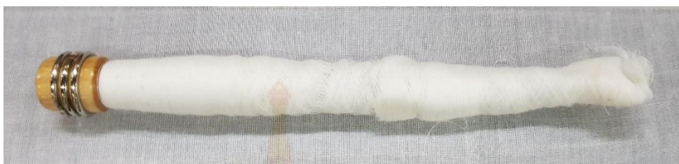
ภาพที่ 4.2 หลอดกรอนิมเกิดปัญหาเส้นด้ายหลุดระหว่างทอ
