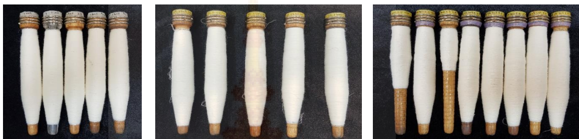
ภาพที่ 4.1 หลอดกรอด้ายที่กรอผ่านลูกเหล็กขนาด 15, 16.5 และ 18 มิลลิเมตร ตามลำดับ
