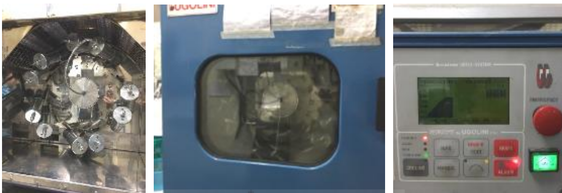
ภาพที่ 3.29.การทดสอบการย้อมด้วยเครื่อง IR ยี่ห้อ UgoLine
