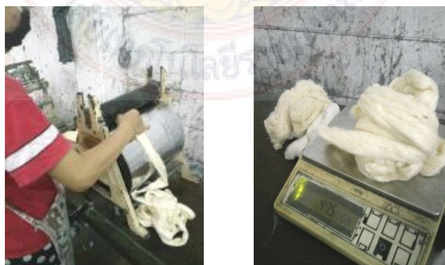
ภาพที่ 3.20 การทดสอบหาน้ำหนักของ Sliver หลังผ่านเครื่อง Draw Flame
