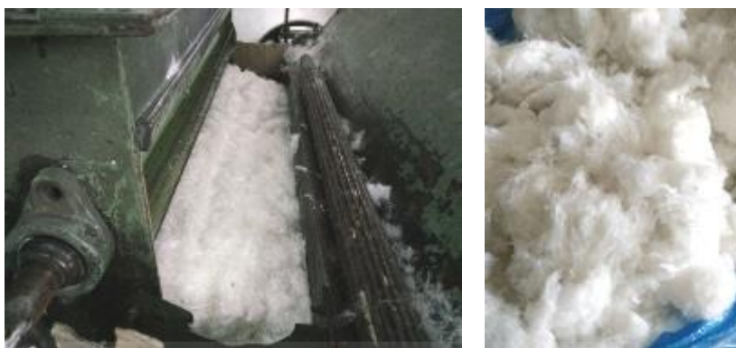
ภาพที่ 3.15 เส้นใย Web ก่อนส่งไปเครื่อง Carding
