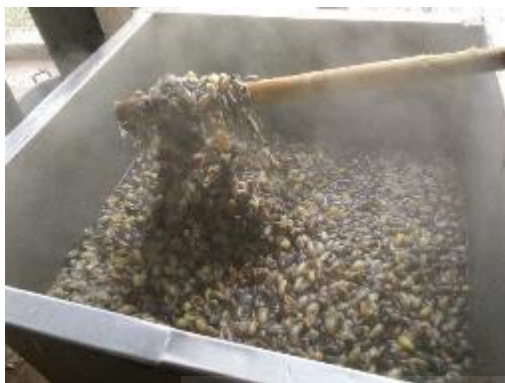
ภาพที่ 3.6 วิธีการทำการลอกกาว เศษไหมและไหมที่สาวเส้นไม่ได้
