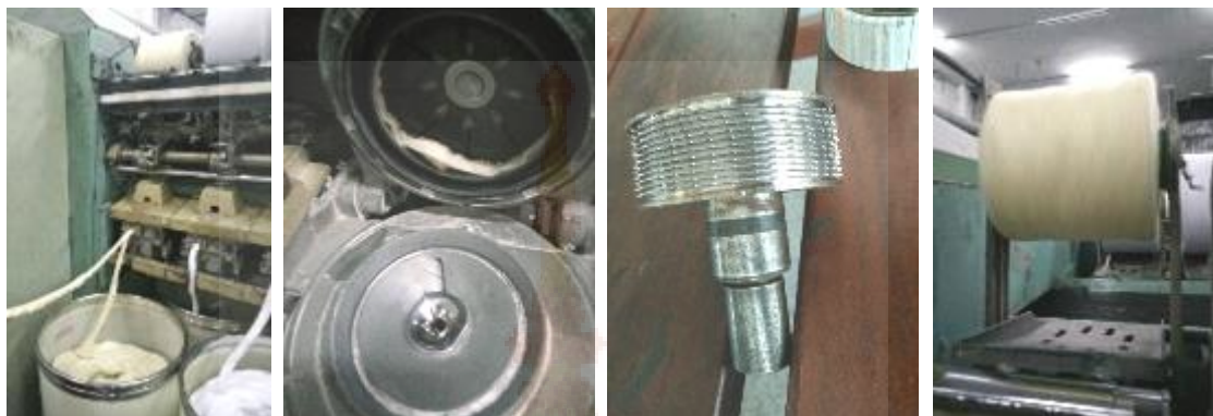
ภาพที่ 3.21 กระบวนการปั่นเส้นด้ายปลายเปิดแบบลูกถ้วย
