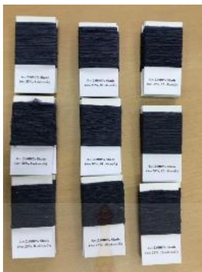
ภาพที่ 4.5 เส้นด้ายที่ปั่นได้มาทดลองย้อมสีน้ำเงิน 2.0%
