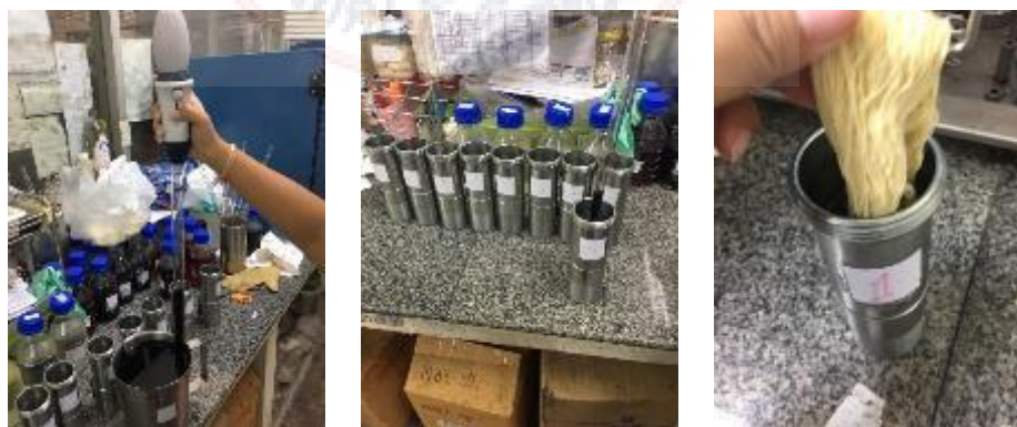
ภาพที่ 3.28 การเตรียม Stock สีสำหรับการย้อม
