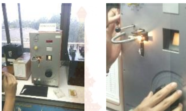
ภาพที่ 3.23 การทดสอบขนาดของเส้นใยด้วยเครื่อง Vibroscope
