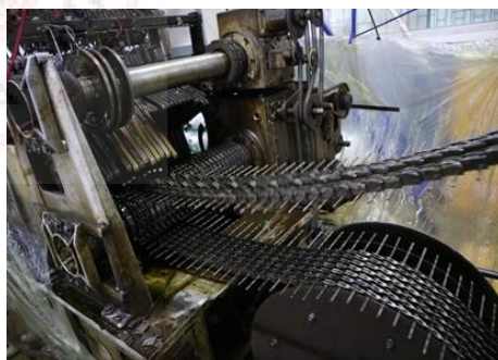
การติดตั้งโซ่ลายบนเครื่อง
