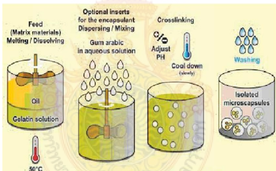
รูปที่ 2. 9 กระบวนการเตรียมไมโครแคปซูลด้วยเทคนิค Coacervation-phase separation
