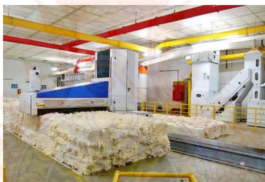
รูปที่ 2.2.1 เครื่องผสมและทำความสะอาดเส้นใย (blow room machine) ที่มา (“Flow Chart of Blow Room in Cotton Spinning” 2019)
