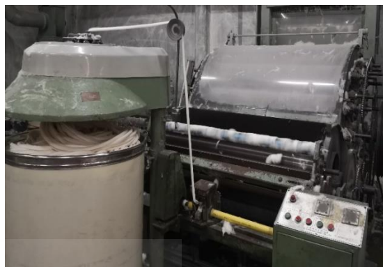
เครื่องสาวใยที่ไม่มีอุปกรณ์ Top Flats
