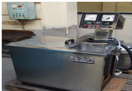
ใส่กระบอกทดลองในเครื่องซ้อมลินีเทสต์ ที่อุณหภูมิ 100 องศาเซลเซียส 60 นาที
