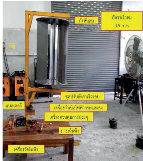
ภาพที่ 2 การทดสอบกังหันลมผลิตไฟฟ้าชนิดแกนแนวดิ่ง
