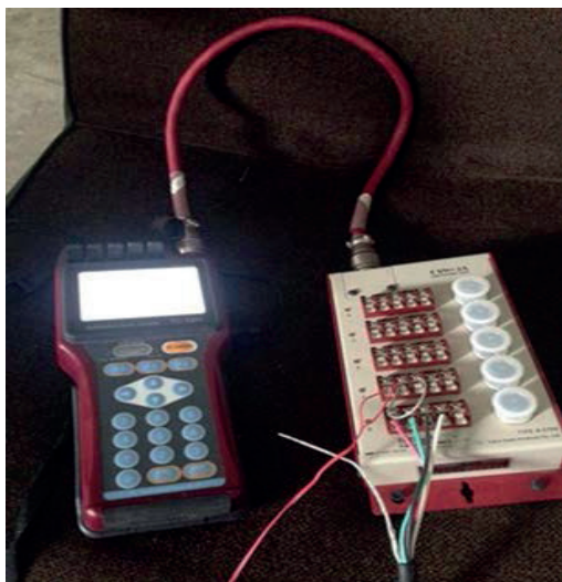
ภาพที่ 3 การติดตั้งอุปกรณ์เพื่อทดสอบ MOR และ TSC ของคอนกรีต
