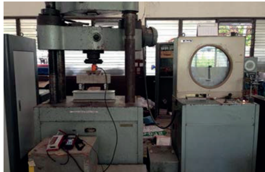
ภาพที่ 2 Data Logger ที่ใช้บันทึกแรงและความเครียด
