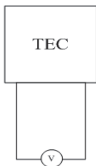
ภาพที่ 3 ลักษณะการต่อวงจรของเทอร์โมอิเล็กทริก
