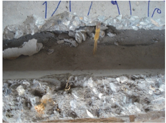
ภาพที่ 6 ลักษณะการขาดของไม้ไผ่ตามขวางเมื่อรับ แรงกดสูงสุด
