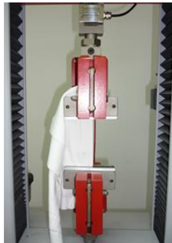
รูปที่ 2 การทดสอบโดยใช้เครื่องทดสอบแรงดึงชนิดอัตราคงที่
