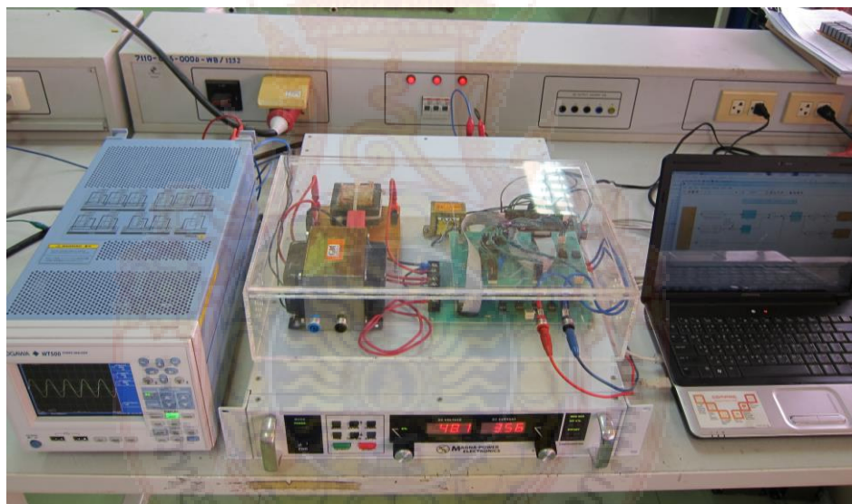
ภาพที่ 4.86 รูปการทดสอบสัญญาณกระแสและแรงดันเอาต์พุตของอินเวอร์เตอร์ขณะต่อเข้าระบบจำหน่ายของการไฟฟ้า
