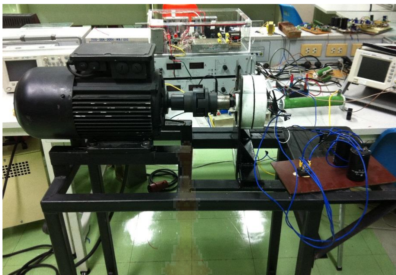
ภาพที่ 4.50 รูปทดสอบหาล้างไฟฟ้าที่ได้จากเครื่องกำเนิดเชิงโรนัสแบบแม่เหล็กถาวรในแต่ละช่วงความเร็ว
