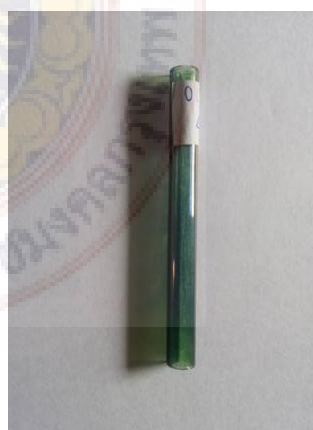
รูปที่ 20 หลอดแก้วที่เคลือบด้วยพอลิอะนิลีน 0.10 M PANi ใน 1.0 M H_2SO_4 กับ 1.0 M ammonium persulfate ในอัตราส่วน 4:1 ที่เวลาในการเตรียมฟิล์ม 30 นาที
