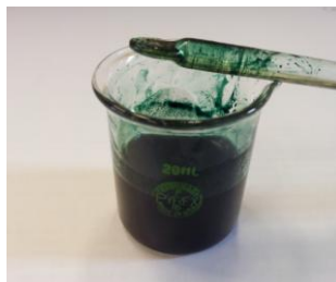
รูปที่ 16 สารละลายสีเขียวของพอลิอะนิลีนในรูป Emeraldine salt จากสารละลายพอลิอะนิลีนจากการผสม 0.1 M PANi ใน 1.0 M HCl กับ 1.0 M ammonium persulfate
