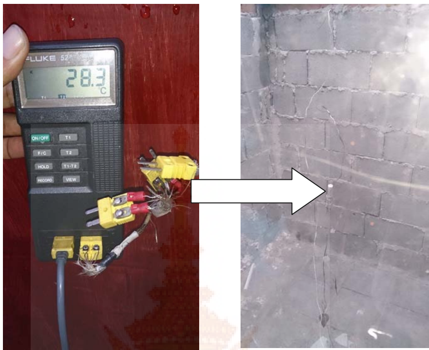
ภาพที่ 4.31 การวัดอุณหภูมิตรงบริเวณกึ่งกลางของโรงอบแห้ง
