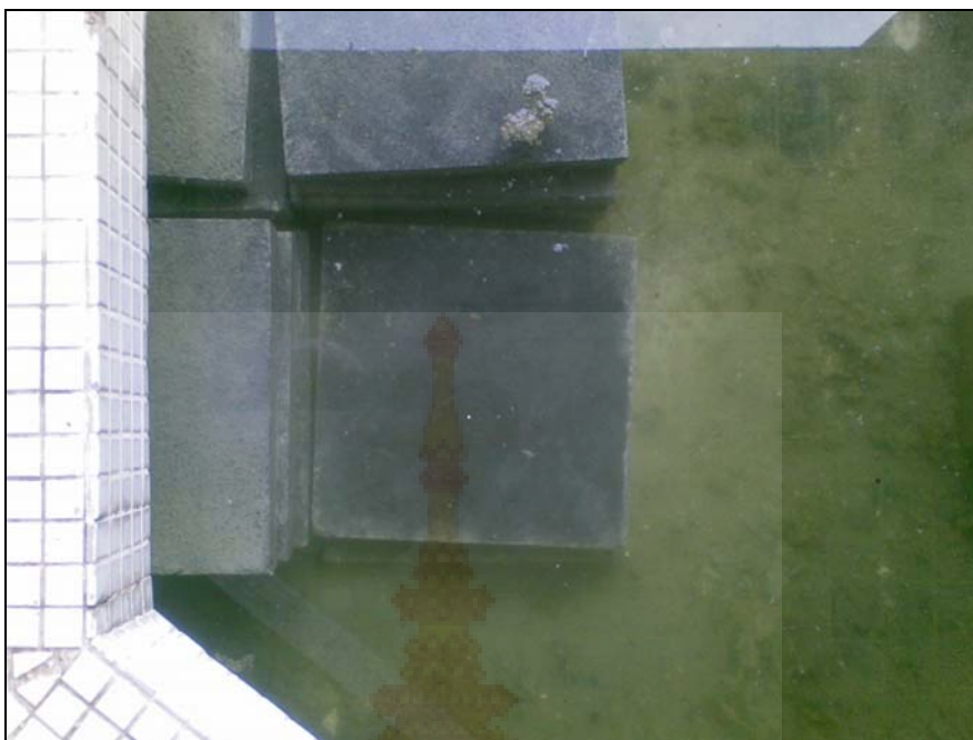
ภาพที่ 3.11 การแตรน้ำเพื่อวัดค่าการดูดซึมน้ำ
