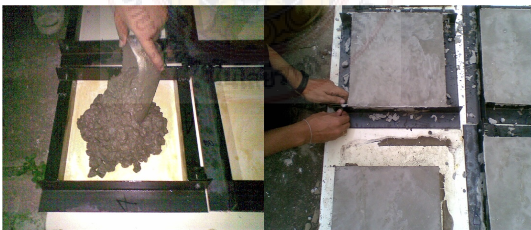
ภาพที่ 3.8 การผสมและถอดแบบคอนกรีตตามมาตรฐาน มอก. 378-2531
