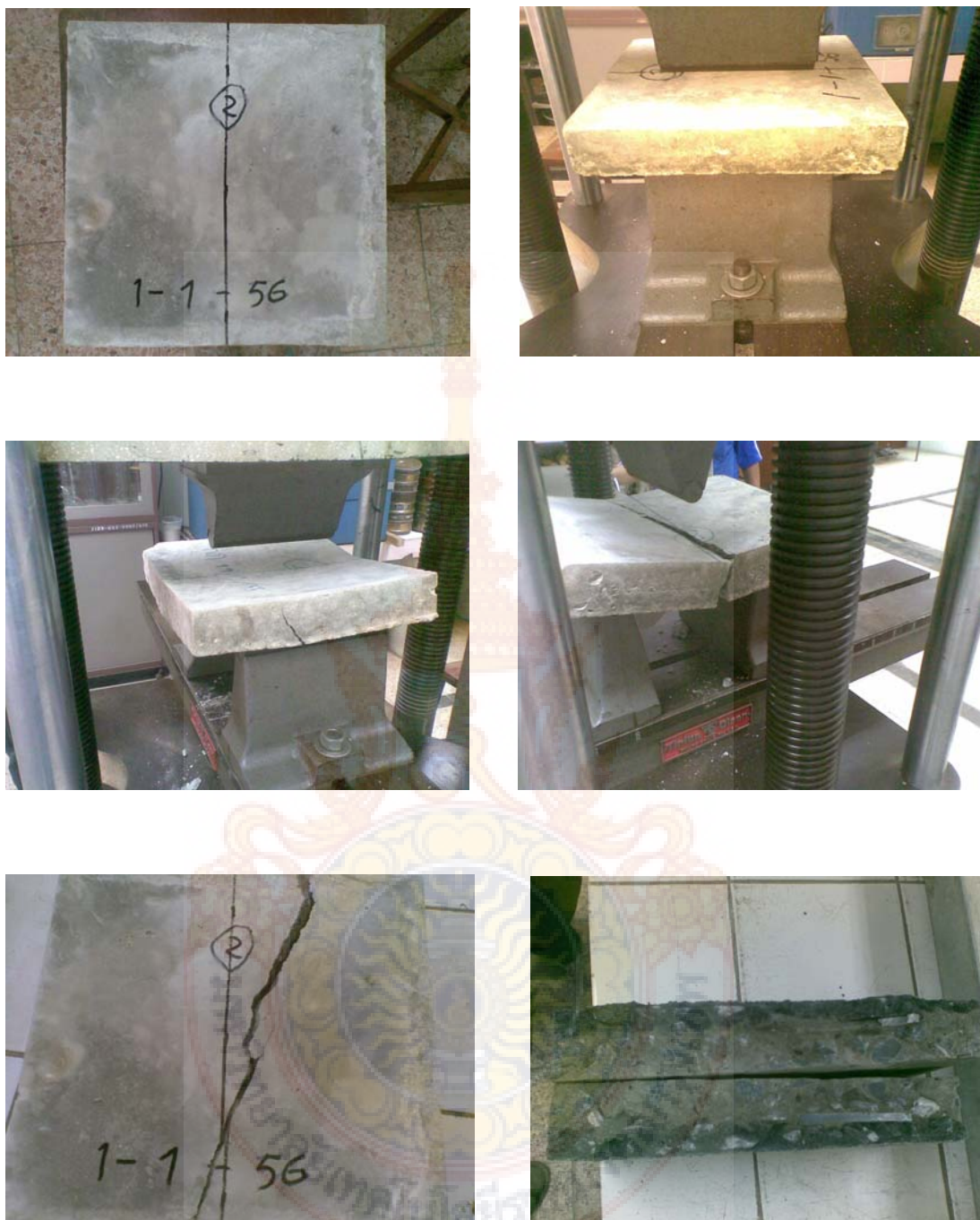
ภาพที่ 3.10 การทดสอบแรงอัดคอนกรีต
