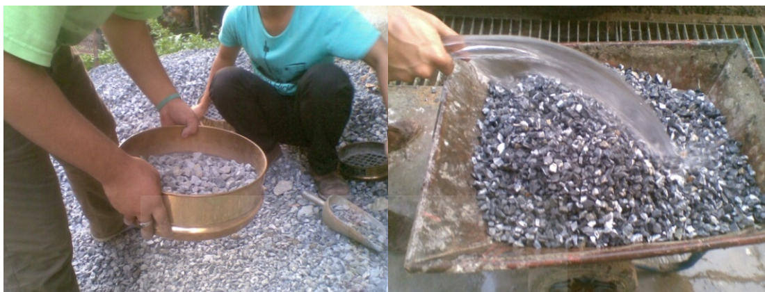
ภาพที่ 3.4 ร้อนหินผ่านตะแกรงขนาด 3/4 นิ้ว และล้างทำความสะอาดหิน
